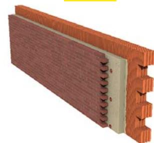
**СРАВНЕНИЕ ТЕРМОИЗОЛЯЦИОННЫХ МАТЕРИАЛОВ ДЛЯ СТЕН**  $U_c = 0,30 \text{ W/m}^2\text{K}$
